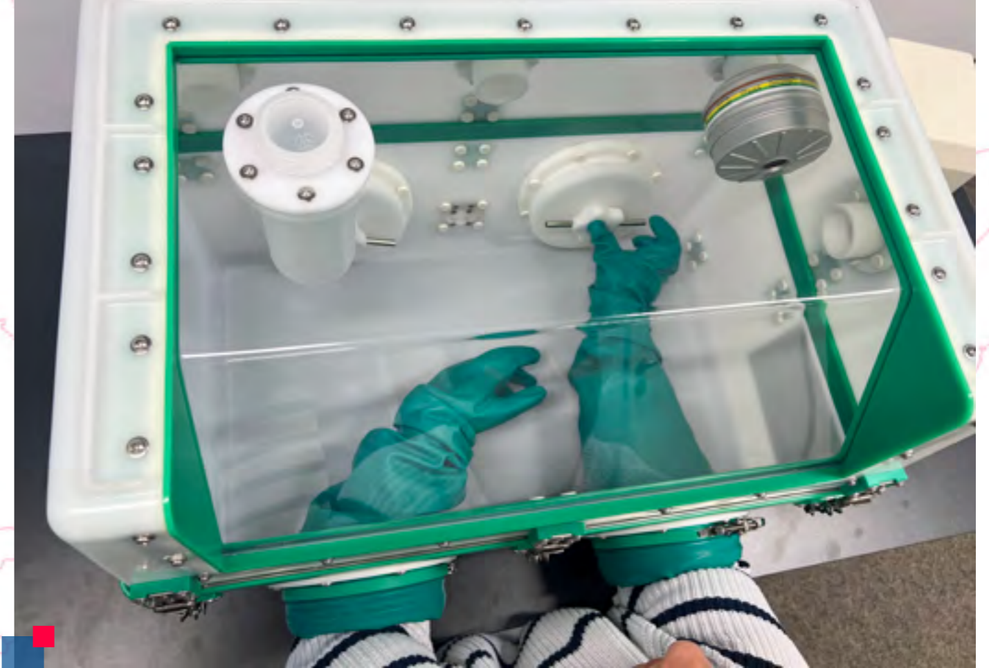
Demonstration beim BNITM: In einem Handschuhkasten kann eine definierte Atmosphäre zur sicheren Bearbeitung von infektiösen Proben erzeugt werden.
